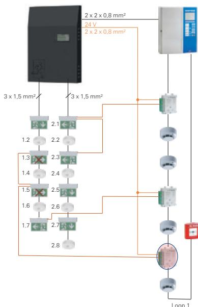
**ANSCHLUSSSCHEMA:** **Beispiel:** RIVA-Leuchten in Verbindung mit Brandmeldeanlage und CPS/LPS
