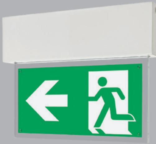
Gehäuse aus Stahlblech, pulverbeschichtet in weiß. Lieferbar als Wandparallel und Deckenmontage mit 10 mm dicker Lichtlenkscheibe und austauschbaren Piktogrammen. Wahlweise mit 1 bzw. 2 Watt LED-Leiste erhältlich.
