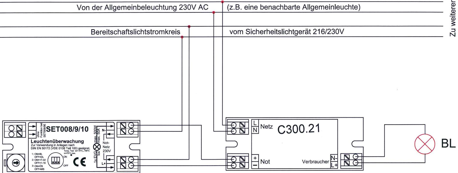
DLS Schaltung (Mitnahmeschaltung) über eine NUS. Beim Einschalten der Allgemeinbeleuchtung wird die DLS Leuchte über die NUS eingeschaltet. Der Verbraucherstrom kommt im Normalbetrieb aus der Allgemeinbeleuchtung. Die Einschaltung über SET008/9/10 (Not- oder Testbetrieb) hat Vorrang.
