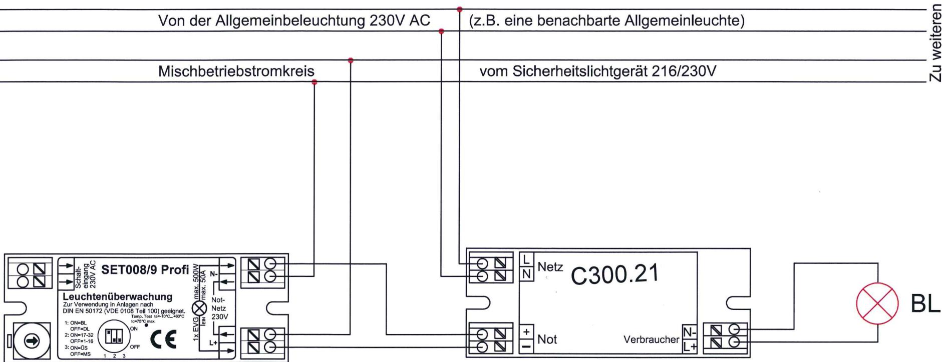
DLS Schaltung (Mitnahmeschaltung) über eine NUS. Beim Einschalten der Allgemeinbeleuchtung wird die DLS Leuchte über die NUS eingeschaltet. Der Verbraucherstrom kommt im Normalbetrieb aus der Allgemeinbeleuchtung. Die Einschaltung über SET008/9 (Not- oder Testbetrieb) hat Vorrang.
