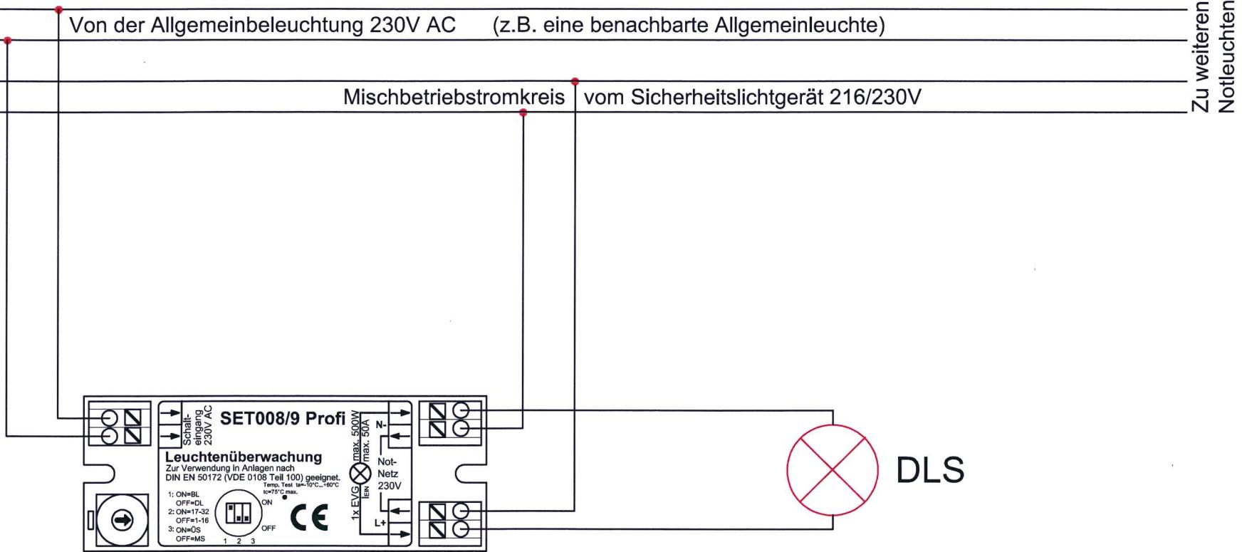
DLS Schaltung (Mitnahmeschaltung) über einen SET008/9 Profi Überwachungsbaustein. Beim Einschalten der Allgemeinbeleuchtung wird die DLS Leuchte über den SET008/9 Profi eingeschaltet. Der Verbraucherstrom kommt immer aus dem Sicherheitslichtgerät. Die Invertierung der Schaltlogik (Überwachungsschaltung) ist durch DIP3 möglich. Die am Schalteingang anliegende Spannung ist nur eine Steuerspannung.
