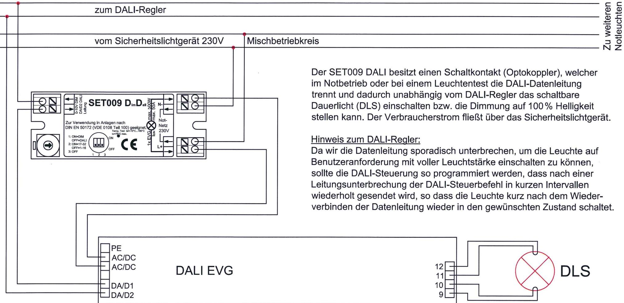
Der SET009 DALI besitzt einen Schaltkontakt (Optokoppler), welcher im Notbetrieb oder bei einem Leuchtentest die DALI-Datenleitung trennt und dadurch unabhängig vom DALI-Regler das schaltbare Dauerlicht (DLS) einschalten bzw. die Dimmung auf 100% Helligkeit stellen kann. Der Verbraucherstrom fließt über das Sicherheitslichtgerät.
