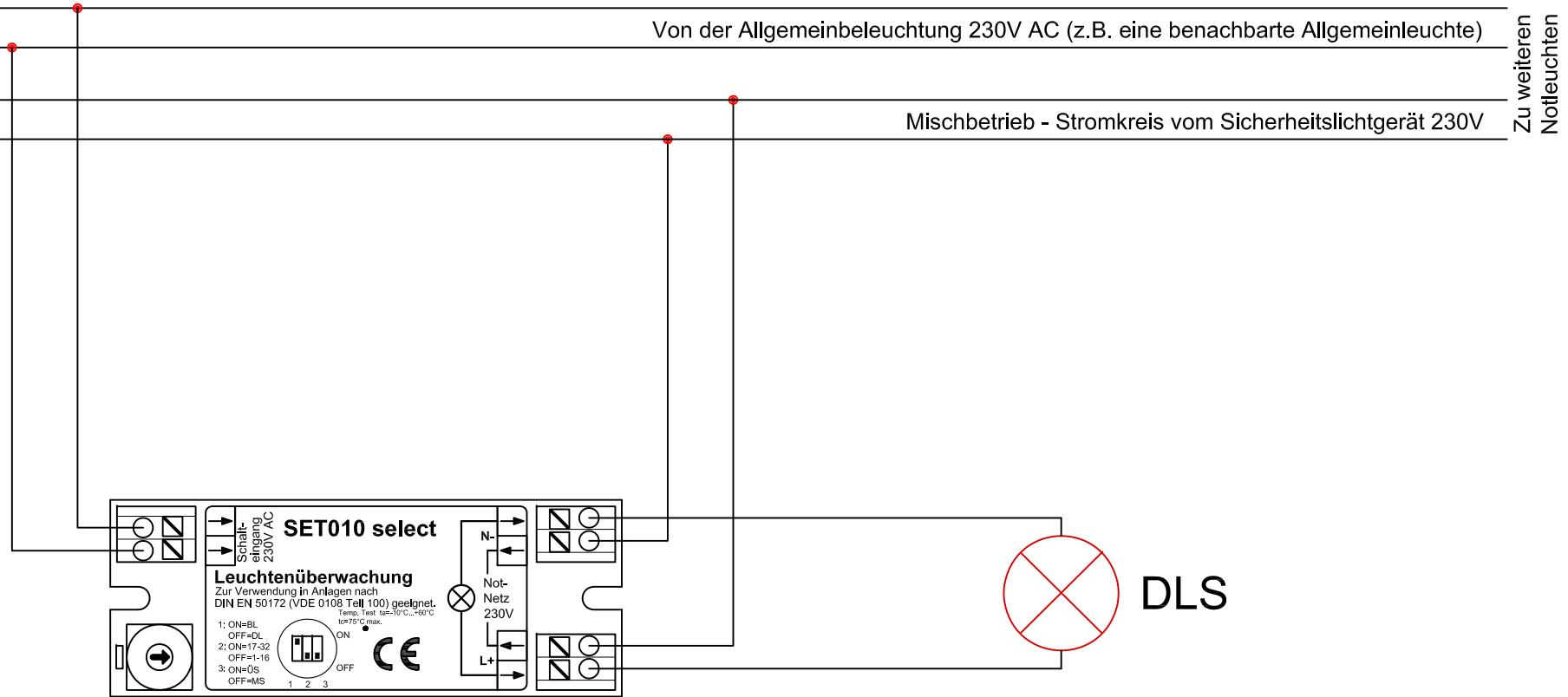
DLS Schaltung (Mitnahmeschaltung) über einen SET010 select Überwachungsbaustein. Beim Einschalten der Allgemeinbeleuchtung wird die DLS Leuchte über den SET010 select eingeschaltet. Der Verbraucherstrom kommt immer aus dem Sicherheitslichtgerät. Die Invertierung der Schaltlogik (Überwachungsschaltung) ist durch DIP3 möglich. Die am Schalteingang anliegende Spannung ist nur eine Steuereinspannung.
