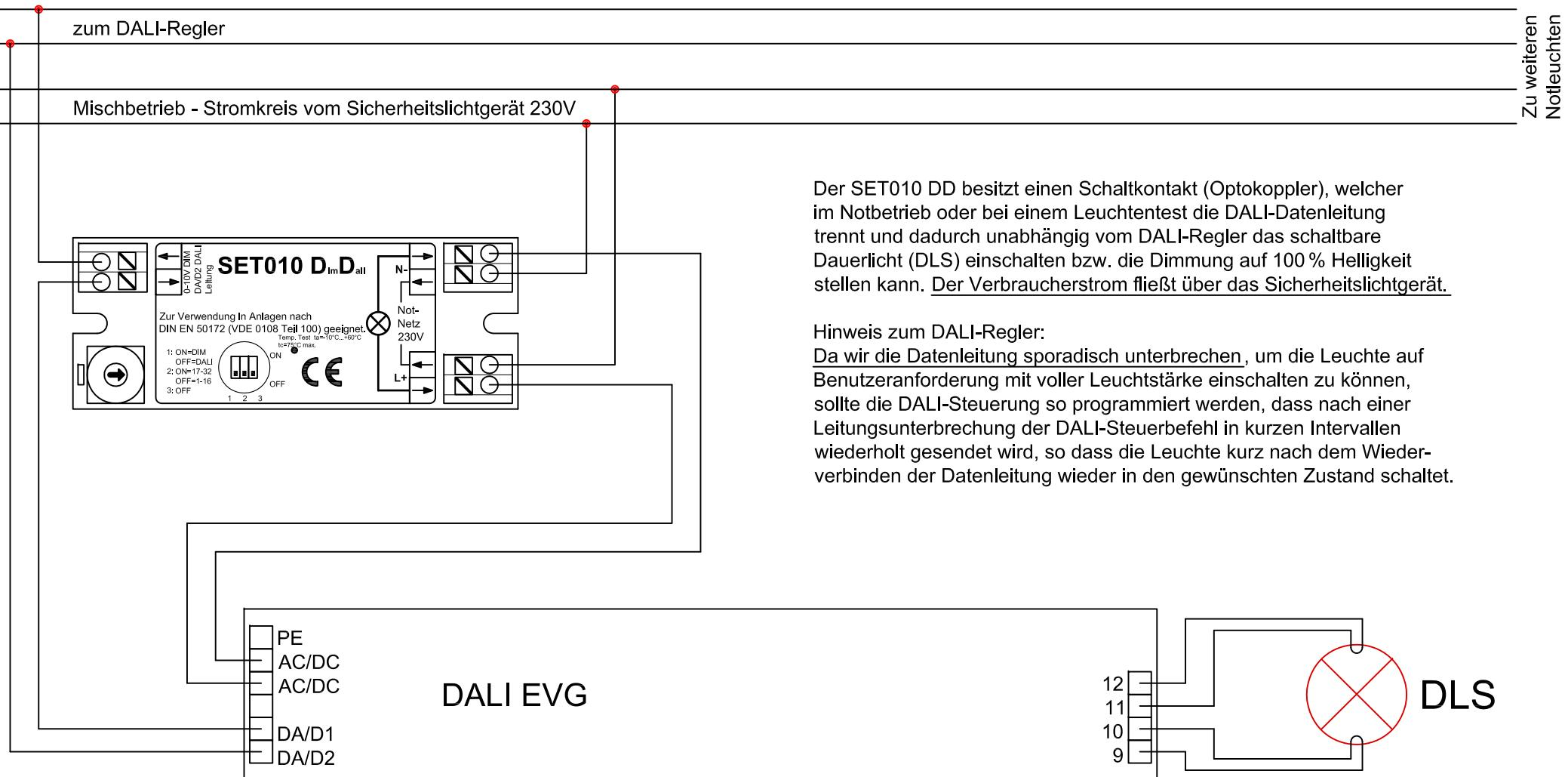
Der SET010 DD besitzt einen Schaltkontakt (Optokoppler), welcher im Notbetrieb oder bei einem Leuchtentest die DALI-Datenleitung trennt und dadurch unabhängig vom DALI-Regler das schaltbare Dauerlicht (DLS) einschalten bzw. die Dimmung auf 100 % Helligkeit stellen kann. Der Verbraucherstrom fließt über das Sicherheitslichtgerät.
