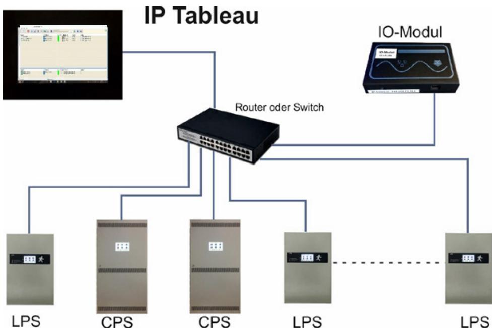
1. Die Anlagen können über ein vorhandenes Firmennetzwerk verbunden werden. Die Anlagen beziehen dann Ihre IP-Adresse automatisch von dem im Netzwerk installierten DHCP-Server (Router). Bei vorhandenem WLAN kann das Tableau dann auch über WLAN mit den LPS Geräten kommunizieren.
